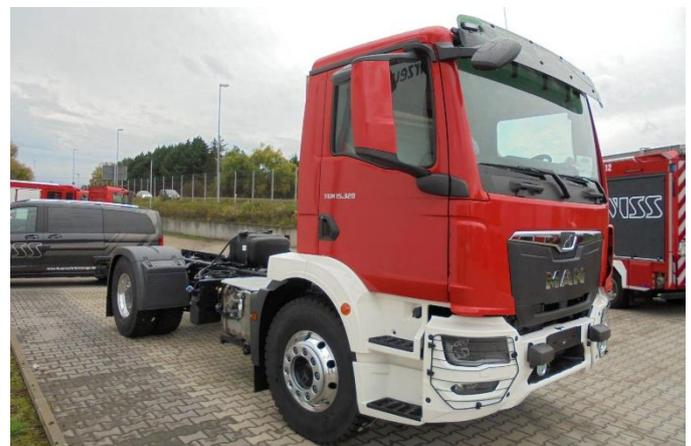
Das Fahrgestell des neuen Löschgruppenfahrzeug 10.
